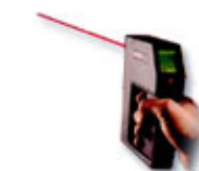
anemometru cu fir cald VT 100 KIMO (Franța)
